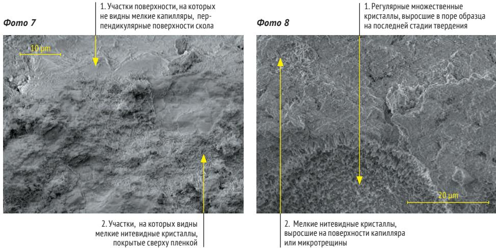
гор, помните? Посмотрите, например, на ставшие видимыми кристаллы **по стрелке 1** (фото 8), вытянувшиеся своеобразным «лесом» (!) внутрь порового пространства. Или – на чащу нитевидных кристаллов **по стрелке 2** (фото 8), собравшихся в пустоте крупного капилляра, который открылся при разломе образца...
