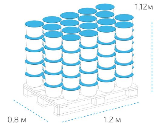
Температура транспортировки СТИЗ В: от минус 13 °С до 35 °С. Допускается транспортирование герметика при температуре до минус 20 °С, при этом общее время его транспортирования при отрицательной температуре не должно превышать 30 суток, а количество циклов замораживания/размораживания должно составлять не более 10. Фактические данные по размерам и весу могут незначительно отличаться.
